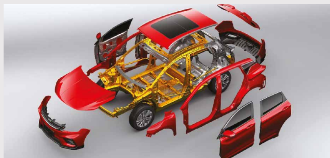
Кузов из разных видов стали
